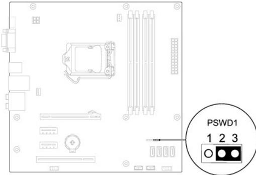
4. Retirez le cavalier à 2 broches des broches 2 et 3, puis insérez-le dans les broches 1 et 2.
